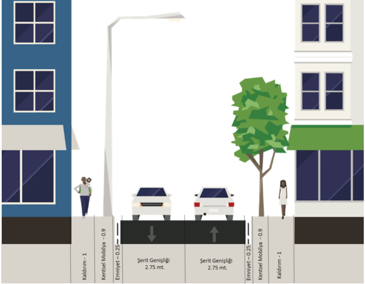
Şekil 20: 2x1 ( 2 Yönde 1'er Şerit ) Yol En Kesiti (minimum ölçüler- 9.8 metre)
