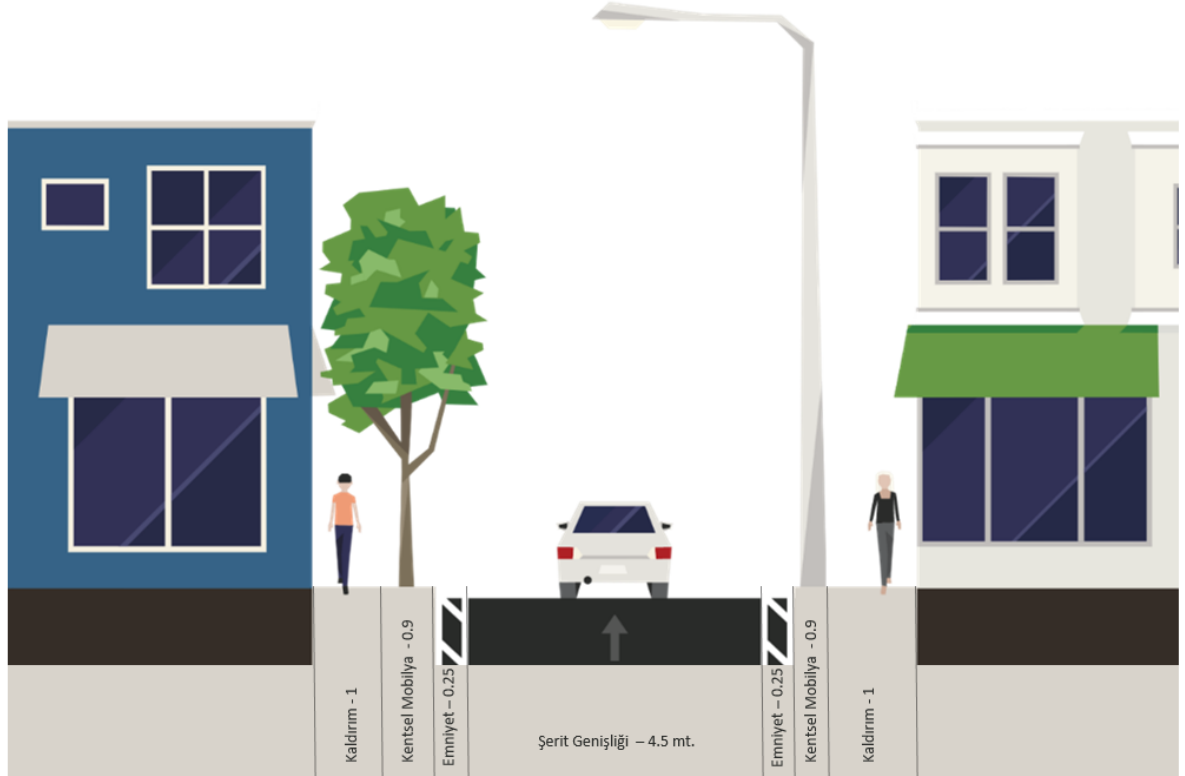
Şekil 18: 1x1 (1 Yönde 1 Şerit) Yol En Kesiti (minimum ölçüler- 8.8 metre)
