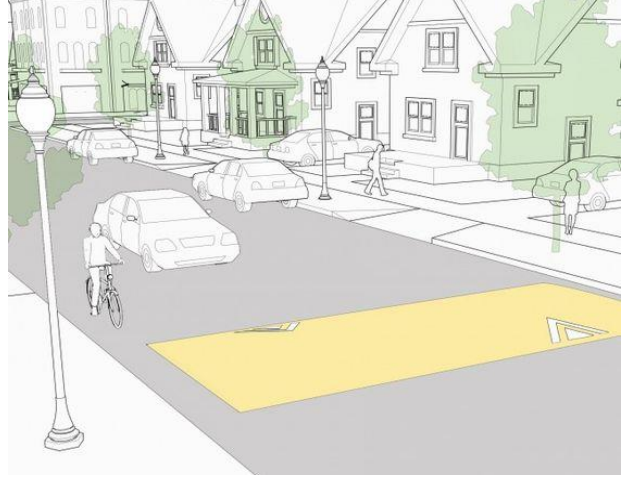
Şekil 42 : Hız Kesici Platform Örneği
