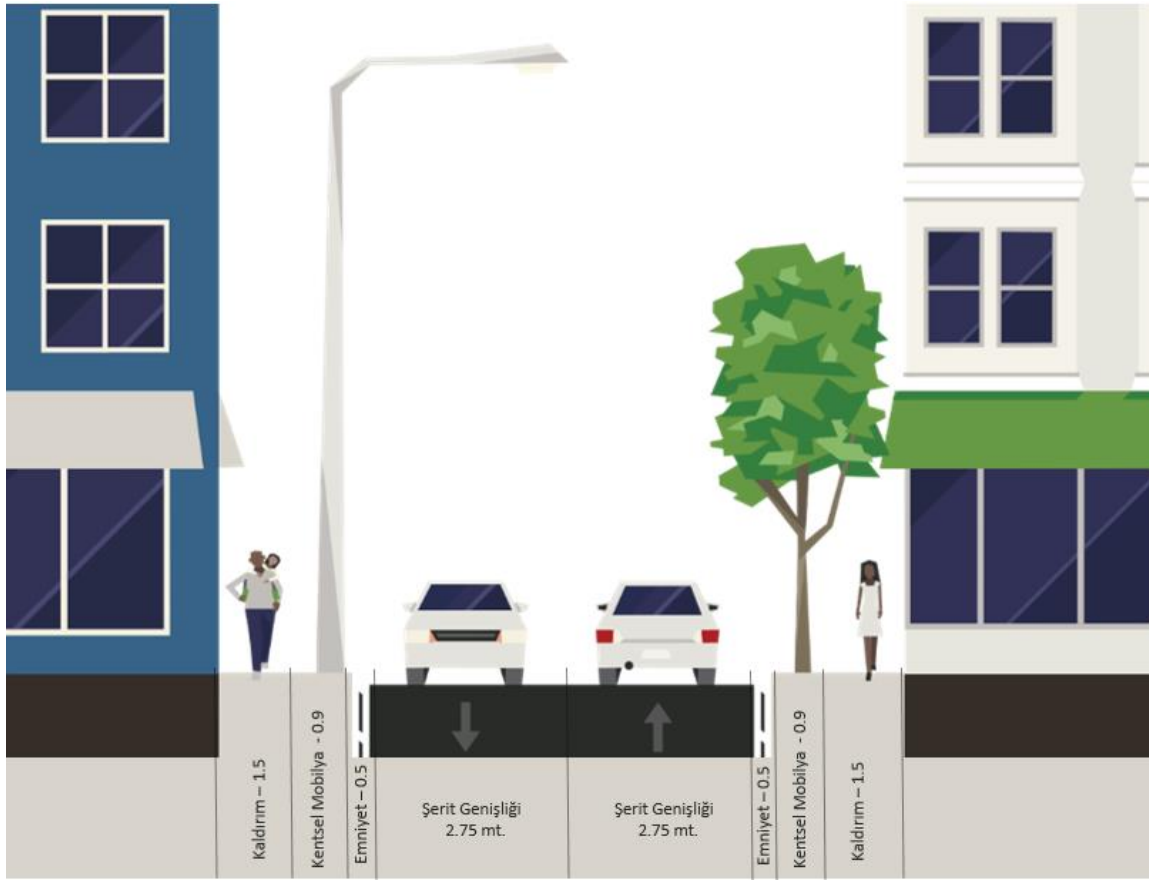
Şekil 28: 2x1 ( 2 Yönde 1'er Şerit ) Yol En Kesiti (minimum ölçüler- 11.3 metre)
