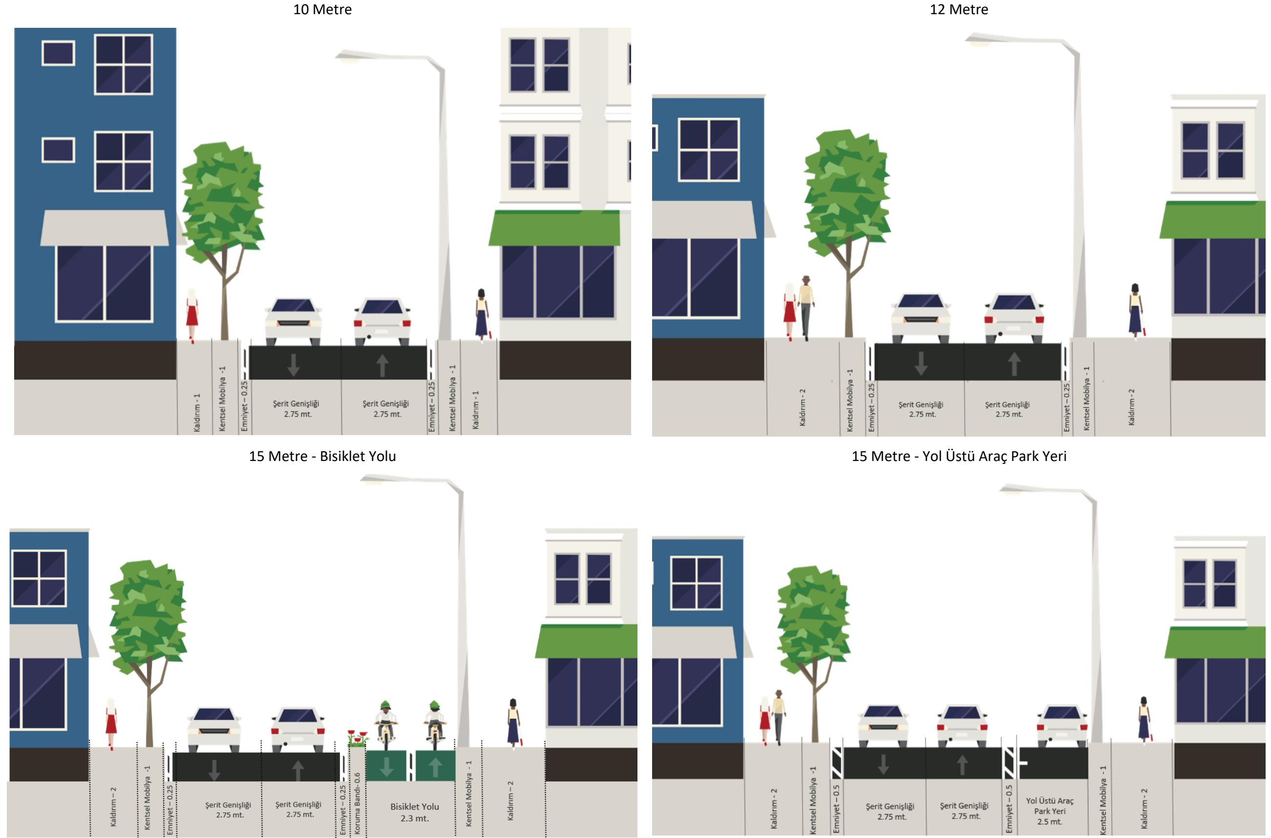
Şekil 21: 2x1 (2 Yönde 1'er Şerit) Yol En Kesiti Örnekleri
