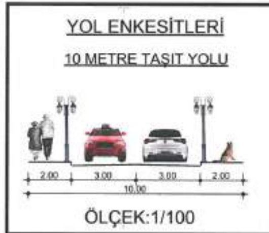
Resim 12: Taşıt yolu Enkesiti
